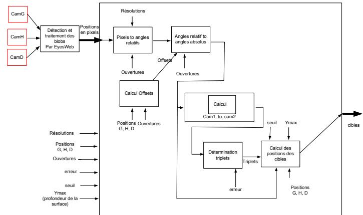
Les calculs établis permettent de localiser, en temps réel, une infinité de cibles en 3D, à partir d'un triplet d'images acquises en employant simplement 3 webcams USB et un PC moyenne gamme.
