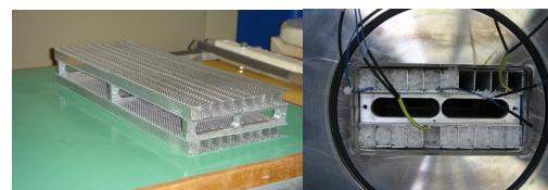
Le réacteur doit pouvoir échanger un maximum de chaleur et disposer d'une faible inertie pour permettre des cycles nombreux et rapides (8-10 min / cycle).
