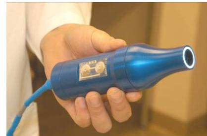
L'appareil est constitué d'un anneau intégrant une source de lumière blanche et d'une camera couleur. Le traitement des images se déroule sur PC.
