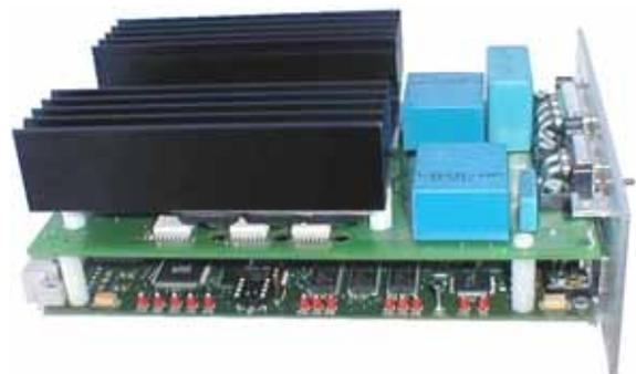
Servo amplificateur (contrôle et puissance)
