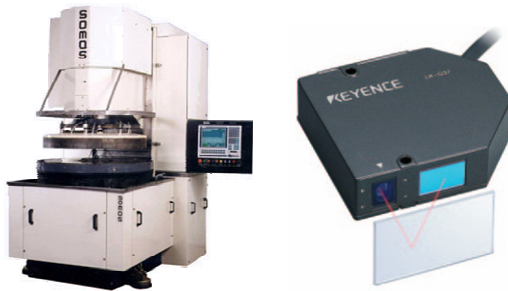
Machine de doucissage et tête de capteur à triangulation laser
