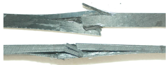
Rupture en compression
