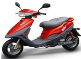
Le système embarqué a été conçu et testé positivement pour être implanté sur un scooter électrique de marque EVT®, modèle 4000e. L'énergie électrique embarquée est stockée dans 4 accumulateurs au plomb. Son autonomie est annoncée à environ 40 [km].
