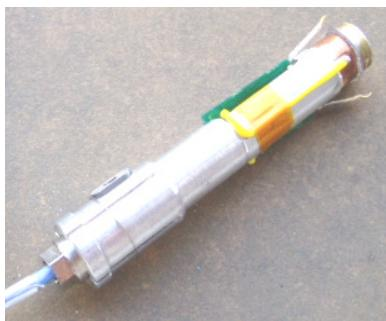
La tête de l'actuateur est un système électromagnétique qui se compose d'un aimant cylindrique polarisé axialement et d'une bobine positionnée juste en dessous. Une partie des lignes de champ de l'aimant traversent la bobine et donc produisent une force selon la loi de Laplace. Le principal défaut de ce système est l'absence de circuit magnétique.
