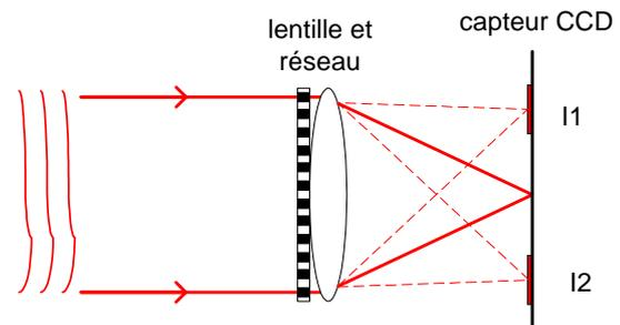
figure 2 : utilisation d'un réseau de diffraction
