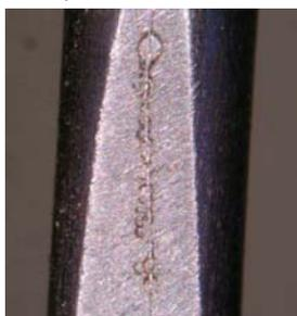
Soudure par point du fil de  $\varnothing 20 \mu m$  sur une tige de  $\varnothing 1 mm$
