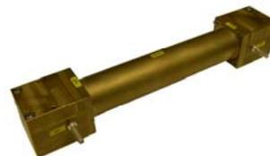
Ces résistances vont servir d'étalons pour la mesure de capacités ainsi que pour la fabrication de résistances calculables de valeurs nominales entières (1 ou 2 k $\Omega$ ).
