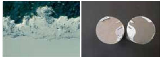
Micrographie du revêtement en coupe, et macrographie de la zone de rupture par essai d'adhérence par traction
