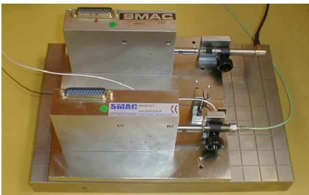
SMAC avec capteurs de force et de position
