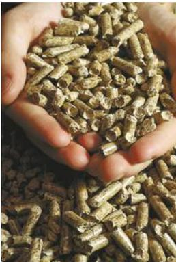
Ce sont de petits cylindres de sciure de bois comprimée d'un diamètre de 5 à 10 mm et d'une longueur maximale de 50 mm. Le taux d'humidité se situe en dessous de 12 %. La masse volumique est de 1150 kg/m<sup>3</sup>. Les granulés sont fabriqués avec du bois naturel, sans additif. Le pouvoir calorifique d'un kilogramme de granulés de bois va de 4,9 à 5,2 kWh. Comme comparaison énergétique, on peut dire que 2 kg de granulés de bois correspondent à environ 1 litre de mazout.
