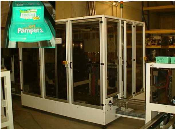
Deckel-Montageautomat für Pampers
