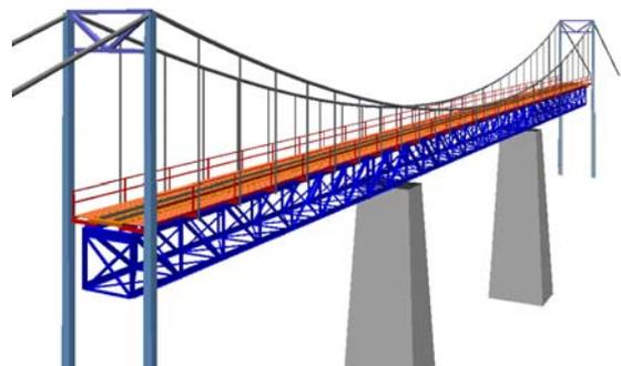
Les appuis intermédiaires qui n'auraient plus de rôle porteurs, seraient alors utilisés pour stabiliser latéralement l'ouvrage.
