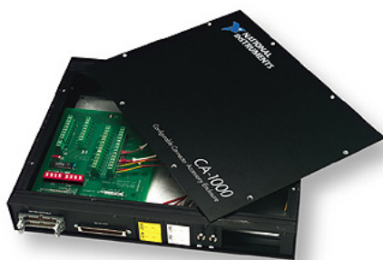
Matériel National Instruments choisi : boîtier CA-1000 avec deux blocs de terminaux isothermes CB-68T reliés à deux cartes PCI NI-4351
