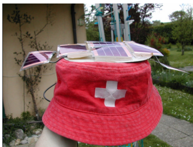
Figure 1 : Prototype du chapeau solaire capable d'alimenter un lecteur MP3, réalisé dans le cadre des laboratoires Physique appliquée par M.Ozkan et M.Wyss (cellules souples de vhf technology).
